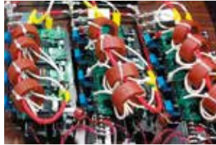
▲USPMを用いた30 kW三相デュアルアクティブブリッジコンバータ
