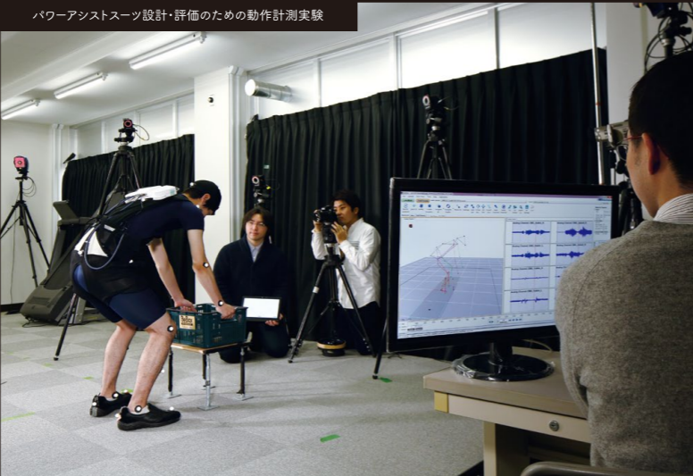
パワーアシストスーツ設計・評価のための動作計測実験
